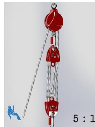
Rescue-ALF - steht für "Rescue - Assist Locking Pulley." Er besteht aus einer Art Umlenkrolle welche mit 11mm Kernmantelseil in beide Seilrichtungen arbeitet. Er blockiert extrem schnell in beide Wirkungsrichtungen, so dass die Sturzhöhe nur wenige cm beträgt, durch die Nutzung von Halbstatischen Seilen ist der Fangstoß minimal.
